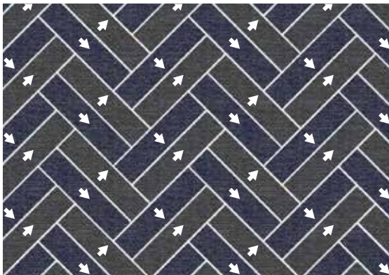
Instalación en espigas realizada en un solo color con lamas cortadas en el sentido de la urdimbre y lamas cortadas en el sentido de la trama.
