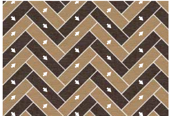
Instalación en espigas realizada en dos colores.
