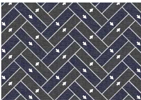
Posa a spina di pesce doppia realizzata con strisce in un solo colore tagliate nel senso dell'ordito e strisce tagliate nel senso della trama.
