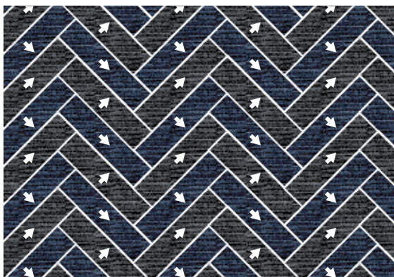
Posa a spina di pesce realizzata con strisce in un solo colore tagliate nel senso dell'ordito e strisce tagliate nel senso della trama.
