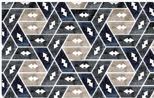
Posa di mezzi esagoni realizzati con due colori.
