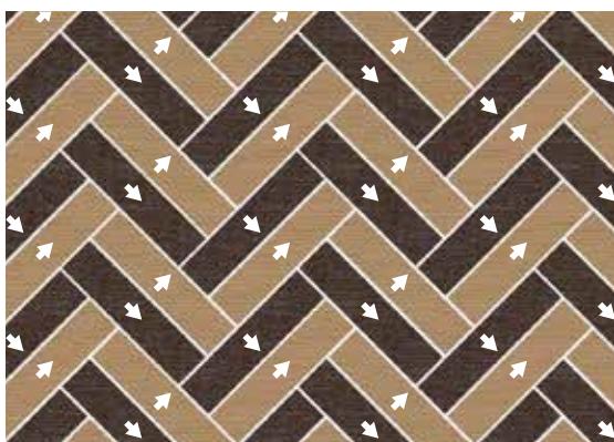
Posa a spina di pesce doppia realizzata con due colori.
