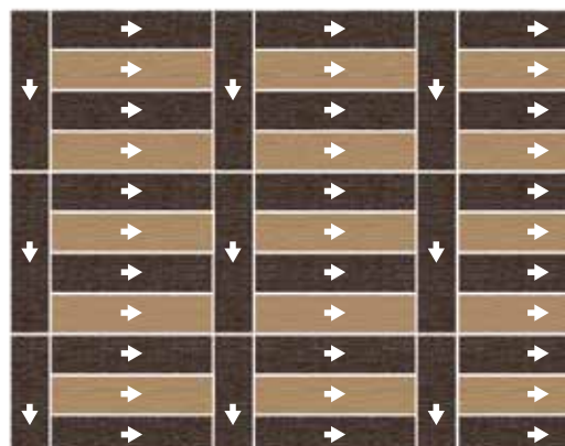
Trapsgewijs plaatsen in twee kleuren.
